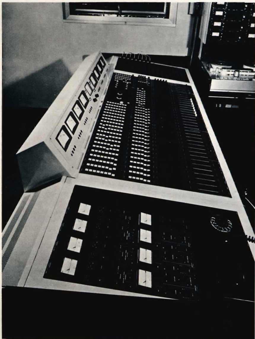
Fig. 1 - Vista del piano di lavoro del tavolo di regia audio realizzato dalla Società Italiana Telecomunicazioni Siemens s.p.a. per lo studio di registrazione della FONORAMA.
