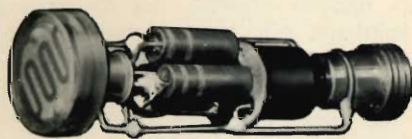
Fig. 5 - Realizzazione del cablaggio in aria.
