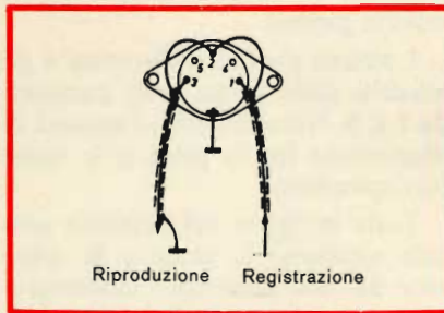
Fig. 7 - Presa per il collegamento fra un registratore a nastro e un amplificatore monofonico.
