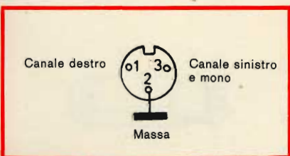
Fig. 13 - Tipica spina DIN a 3 poli di vecchia concezione.
