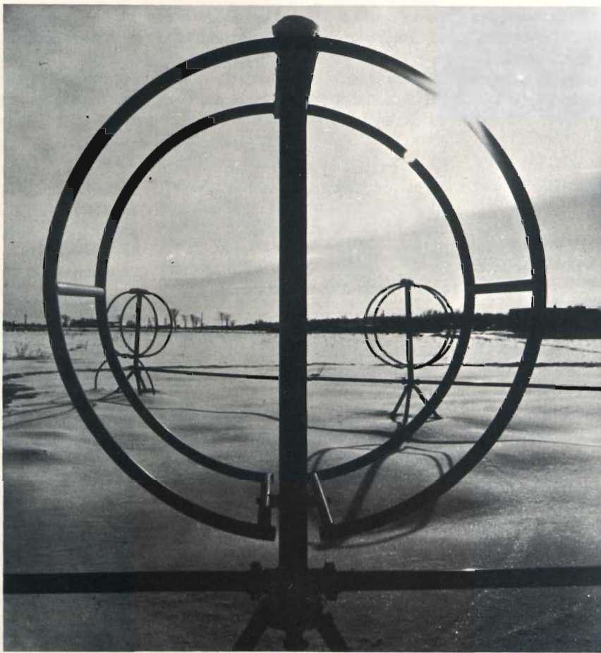
Fig. 1 - Modernissima antenna aperiodica a quadro della HERMES ELECTRONICS LIMITED che mediante un preamplificatore a stato solido consente di coprire le gamme di radiodiffusione fra 2 e 32 MHz. Si tratta di un tipo di antenna che è destinato a sostituire, in ricezione, le antenne rombiche e quelle logperiodiche
