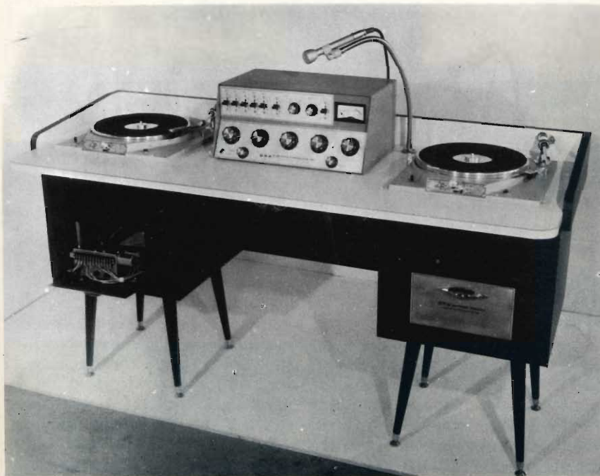
Fig. 2 - Consolle QRK per la registrazione e lo smistamento dei programmi negli studi radiofonici costruita dalla ELECTRONIC PRODUCER di Fresno (Cal.). Si tratta di un sistema altamente funzionale senza dubbio all'avanguardia nel suo specifico campo applicativo.
