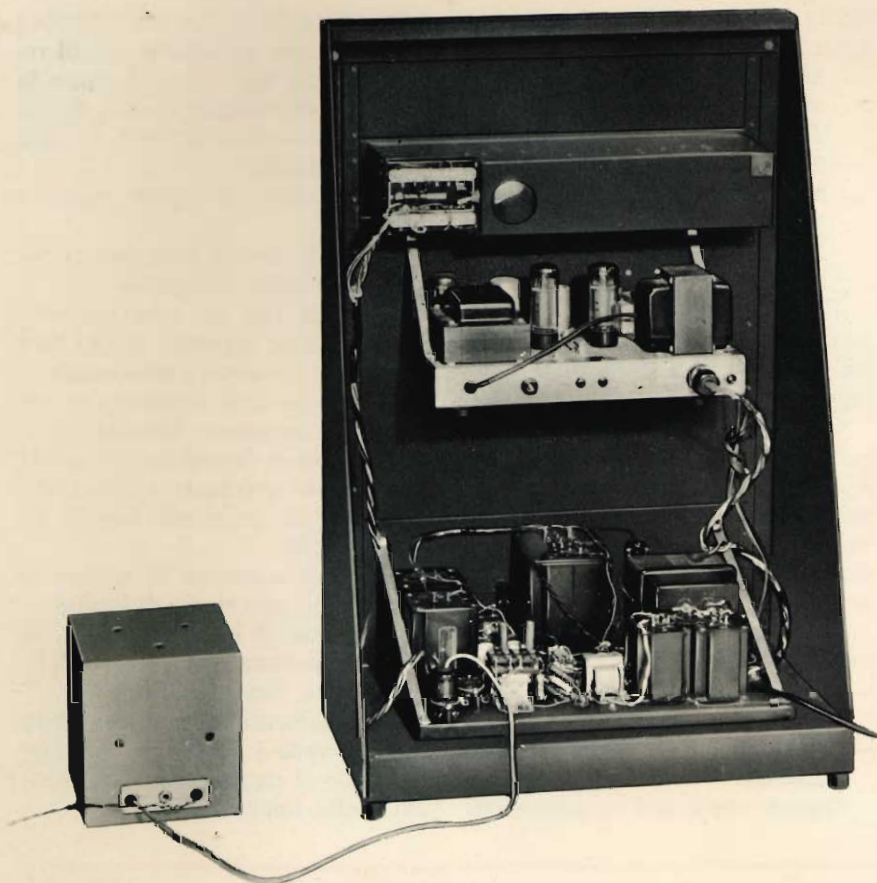
Fig. 4 - Vista posteriore del «Rack» completo di alimentatore (in piano base), modulatore e trasmettitore Millen da 50 W. Si noti la praticità di questo tipo di montaggio.
